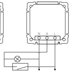
Подключение датчика трехпроводным способом подключения – рис.1.
