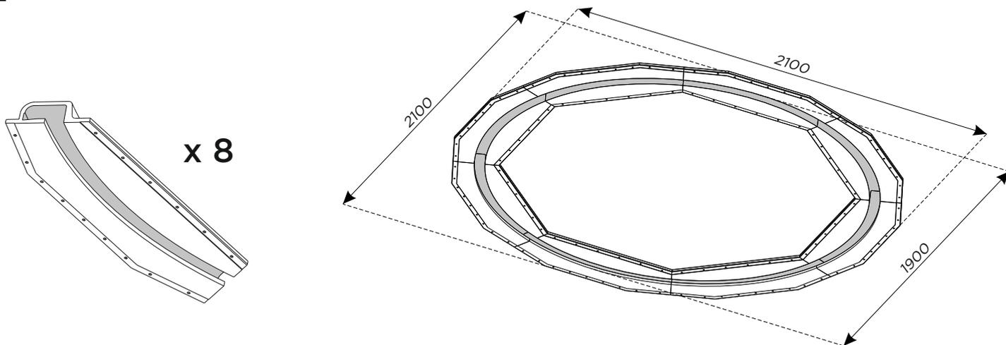
Гипсовый корпус светильника CALYPSO 1900 состоит из 8-ти составных частей.
