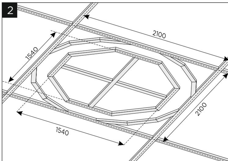
В запланированном месте размещения светильника соберите, заранее, на потолке по указанным на схеме размерам каркас для установки светильника.
