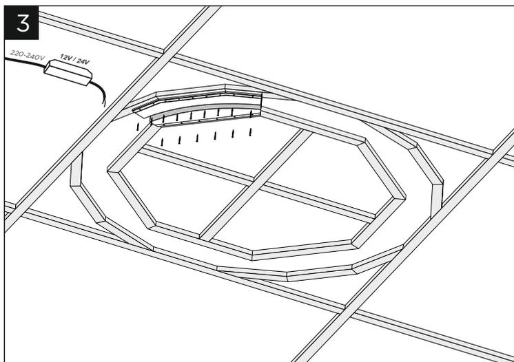
Закрепите 1/8 часть светильника к каркасу потолка с помощью саморезов для гипсокартона.
