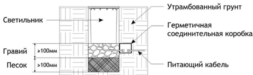
РИС. 1. Схема устройства дренажа при установке светильника.
