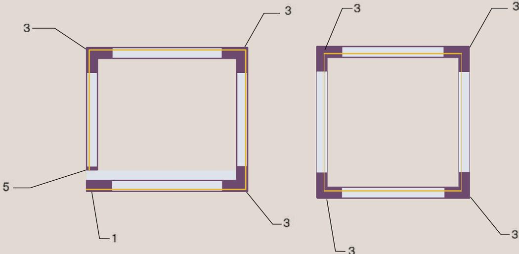
Прямоугольные конфигурации трековой системы могут выполняться как в разомкнутом, так и в замкнутых вариантах. Следует учитывать, что угловые коннекторы в данном случае могут быть либо внешние, либо внутренние.
