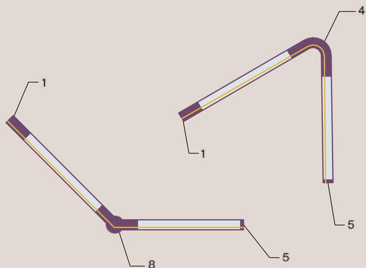
В случаях, когда необходима конфигурация с углами отличными от значения в 90°, применяются гибкие либо шарнирные коннекторы. Гибкий коннектор позволяет делать изгибы как в горизонтальной, так и в вертикальной плоскости, шарнирный имеет возможность только в горизонтальной плоскости.
