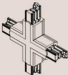
X-образный коннектор - элемент системы, применяемый для формирования конфигураций сложной формы для ответвлений в 4 направления с возможностью ввода питания.
