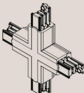
Х-образный коннектор - элемент системы, применяемый для формирования конфигураций сложной формы для ответвлений в 4 направления с возможностью ввода питания.
