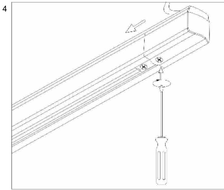
1. Извлеките ввод питания из шинопровода, открутите фиксирующие винты.
