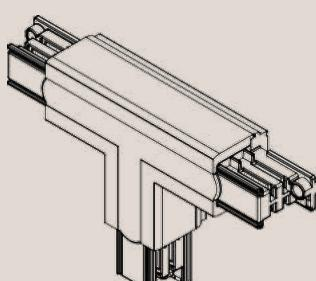
Т-образный коннектор - элемент системы, используемый для организации ответвлений от прямых участков трековой системы влево или вправо с возможностью ввода питания. При применении данного аксессуара в замкнутых конструкциях возможно использование только внешних угловых коннекторов.
