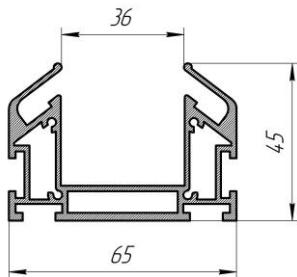
Помимо накладного и подвесного монтажа, возможен вариант с установкой шинопровода в профиль для натяжного потолка. Для осуществления данного варианта в дополнение к трехфазному шинопроводу приобретается профиль TRA005MP-312S и монтаж проводится следующим образом:
