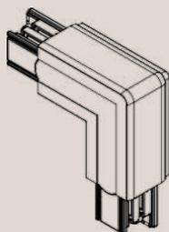
Угловой коннектор - элемент системы, используемый для соединения сегментов шинпровода под углом  $90^\circ$ . Расположение контакта заземления в данном аксессуаре может быть либо с внутренней, либо с внешней стороны угла коннектора. Это стоит учитывать при подборе и сборке систем прямоугольной и ломаной форм.
