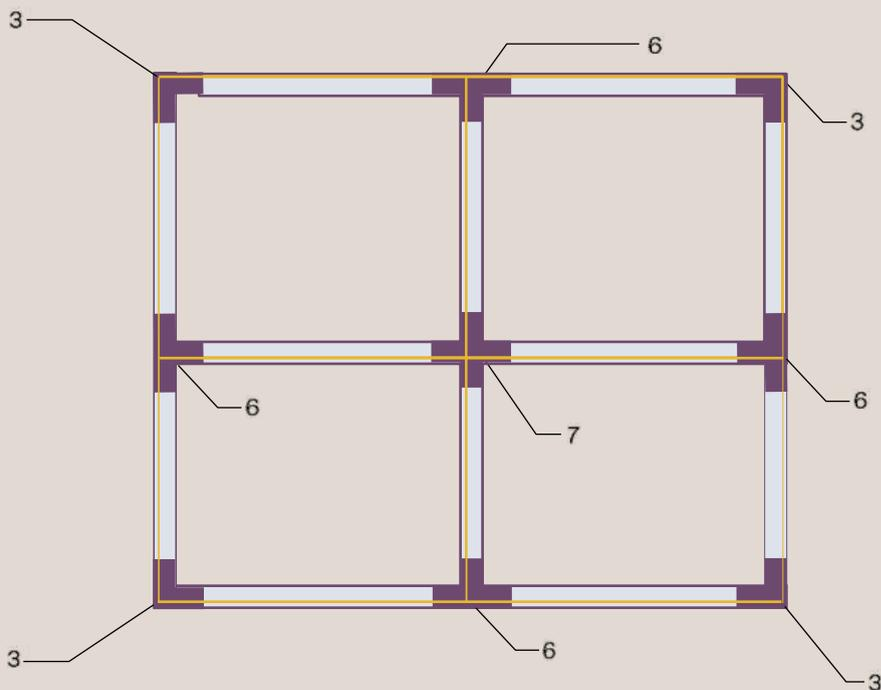
При формировании трековых систем сложной конфигурации возможно использовать как Х-образные, так и Т-образные коннекторы. Для соединения всех ответвлений, как на данном примере потребуются угловые коннекторы. При наличии в системе Т-образных коннекторов допустимо использовать только внешние угловые коннекторы. На противоположных сторонах системы должны применяться разнонаправленные Т-образные коннекторы (если с одной стороны вставлен левый, то напротив него устанавливается правый).
