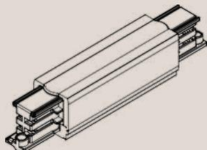
Прямой коннектор питания - аксессуар, применяемый для соединения отдельных отрезков шинпровода в прямую линию с возможностью ввода питания.
