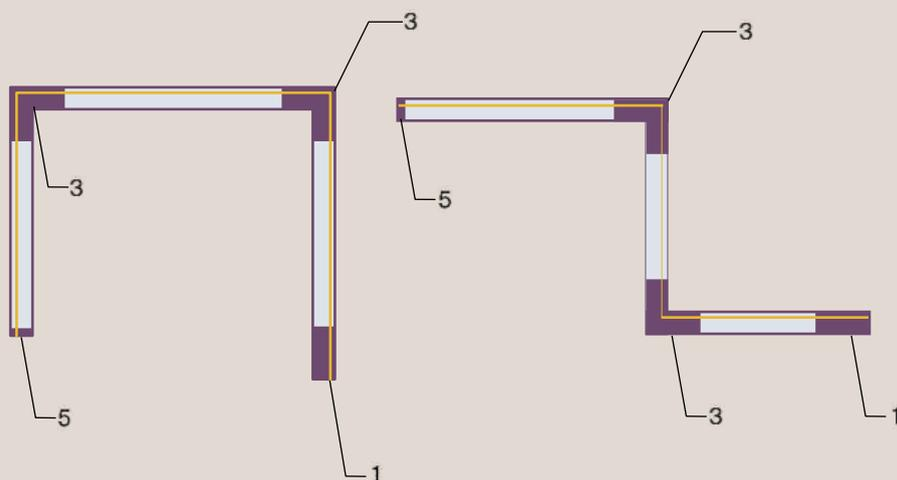
При формировании соединений ломаной формы следует учитывать расположение контакта заземления на протяжении всей системы, чтобы корректно подобрать угловые коннекторы. На варианте слева все угловые коннекторы внешние, а на варианте справа от точки ввода питания сначала идет внутренний угловой коннектор, а затем - внешний.
