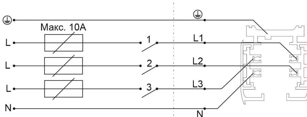
Три независимые линии, управляемые одноклавишными выключателями.
