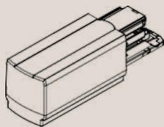
Ввод питания - элемент конструкции, который используется для подведения электропитания к системе. В зависимости от расположения контакта заземления может быть правым или левым. Данный аксессуар входит в комплект каждого отрезка шинпровода (правый).
