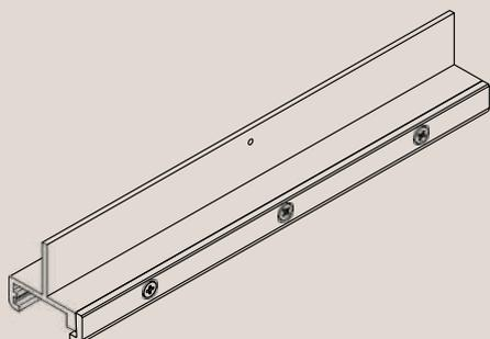
Усилитель стыка - аксессуар, который применяется для жесткой фиксации соединений при подвесном монтаже шинпровода. Используется вместе с тросовым подвесом, если точка крепления приходится на стыкуемое соединение сегментов шинпроводов.
