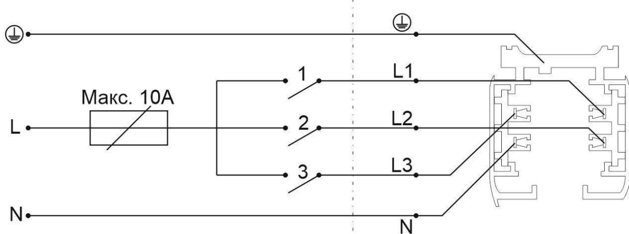
Одна линия, в которой управление разделено с помощью одноклавищных выключателей.
