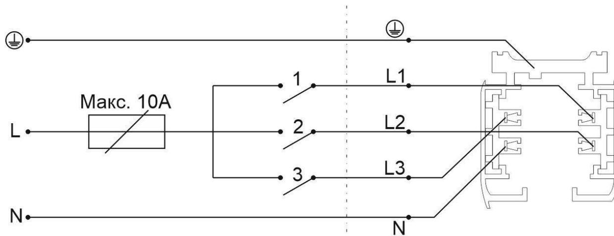
Одна линия, в которой управление разделено с помощью одноклавишных выключателей.
