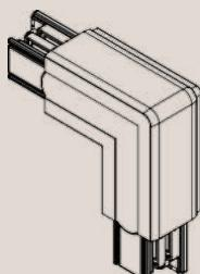
Угловой коннектор - элемент системы, используемый для соединения сегментов шинопровода под углом 90°. Расположение контакта заземления в данном аксессуаре может быть либо с внутренней, либо с внешней стороны угла коннектора. Это стоит учитывать при подборе и сборке систем прямоугольной и ломаной форм.
