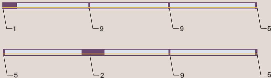
Приведены два примера соединения в прямую линию. На варианте сверху использован ввод питания, в то время как на варианте снизу использован прямой коннектор с возможностью ввода, что позволяет подвести питание к системе из любой удобной точки.
