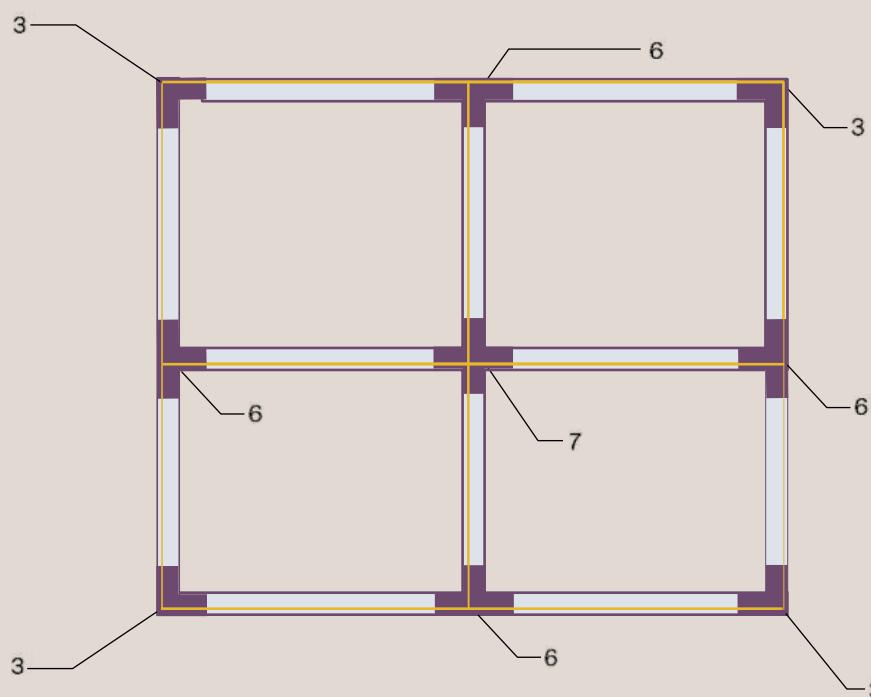
При формировании трековых систем сложной конфигурации возможно использовать как X-образные, так и Т-образные коннекторы. Для соединения всех ответвлений, как на данном примере потребуются угловые коннекторы. При наличии в системе Т -образных коннекторов допустимо использовать только внешние угловые коннекторы. На противоположных сторонах системы должны применяться разнонаправленные Т -образные коннекторы (если с одной стороны вставлен левый, то напротив него устанавливается правый).
