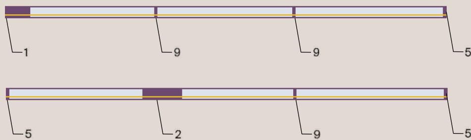
Приведены два примера соединения в прямую линию. На варианте сверху использован ввод питания, в то время как на варианте снизу использован прямой коннектор с возможностью ввода, что позволяет подвести питание к системе из любой удобной точки.
