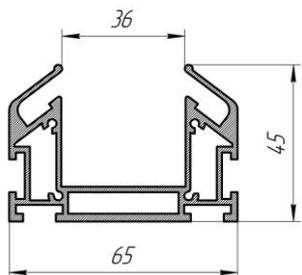
Помимо накладного и подвесного монтажа, возможен вариант с установкой шинопровода в профиль для натяжного потолка. Для осуществления данного варианта в дополнение к трехфазному шинопроводу приобретается профиль TRA005MP-312S и монтаж проводится следующим образом:
