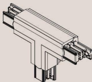
T-образный коннектор - элемент системы, используемый для организации ответвлений от прямых участков трековой системы влево или вправо с возможностью ввода питания. При применении данного аксессуара в замкнутых конструкциях возможно использование только внешних угловых коннекторов.
