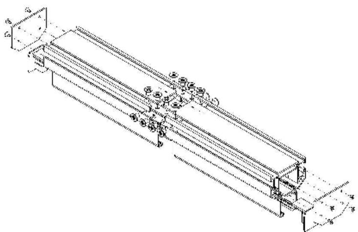
4. Закрепите профиль на поверхности с помощью монтажных уголков.
