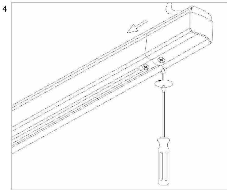
1. Извлеките ввод питания из шинопровода, открутите фиксирующие винты.
