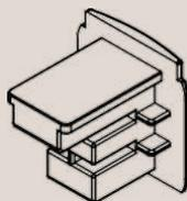
Торцевая заглушка - аксессуар необходимый как для безопасного монтажа, чтобы предотвратить повреждения проводов, декоративных элементов отделки интерьера и во избежание травм об острые края шинпровода, так и выполняет декоративную функцию, закрывая открытый торец шинпровода, поэтому идет в комплект к каждому отрезку шинпровода.
