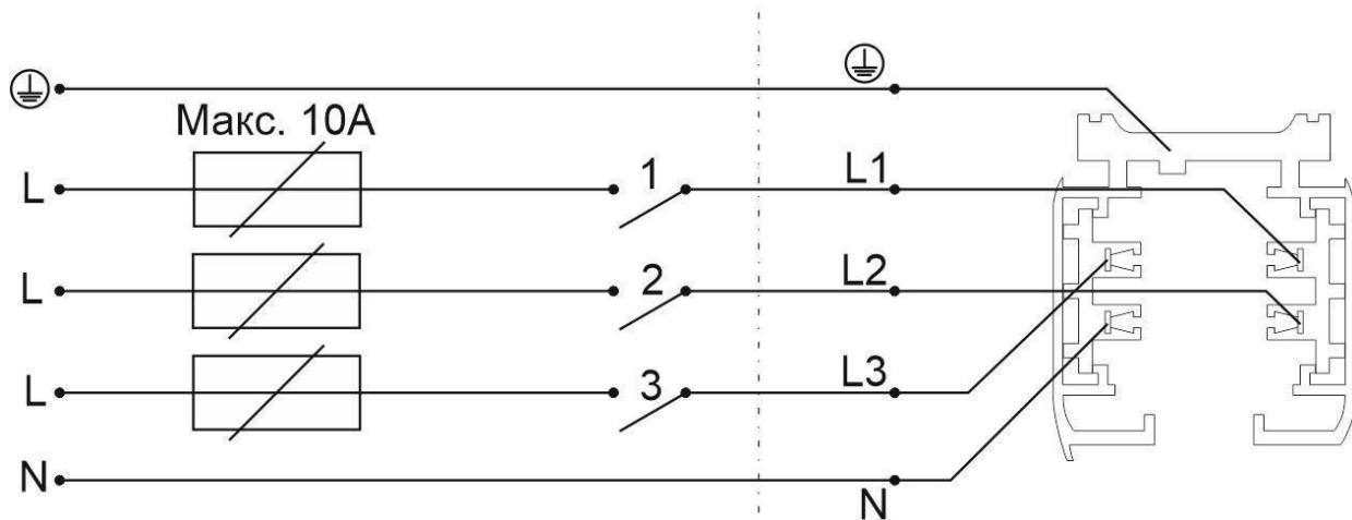
Три независимые линии, управляемые одноклавишными выключателями.
